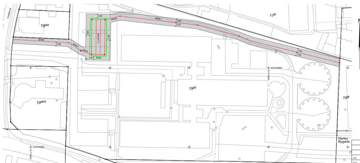
Figur 2.4: Deklarationsbælte af ledningsanlægget i den nordlige del af projektområdet.
